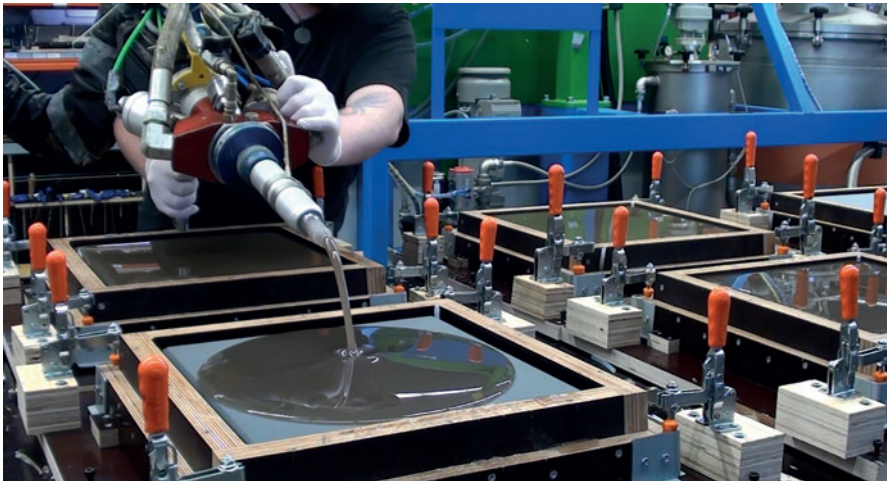
Einblick in die Herstellung von hochwertigen Wetcast-Formen mit maschineller und computergesteuerter Verfahrenstechnik
